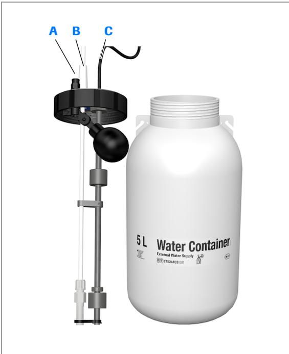
Con el suministro externo de agua, el suministro de agua del laboratorio se conecta al contenedor de agua de 5 litros, que se conecta al analizador de la misma forma que un contenedor de agua convencional. (Las dos salidas de residuos líquidos del analizador están conectadas directamente al sistema de residuos del laboratorio).
